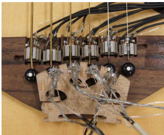
図2 従来型と新型ピックアップの比較
