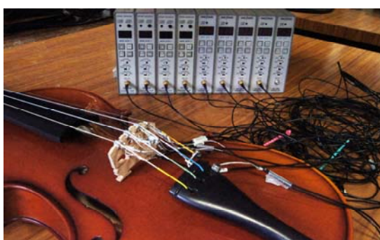
図1 小型ピックアップを設置したバイオリン
