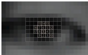
図2 螺旋ラベリングを用いたまばたき検出
