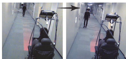
図5 車いすはプロジェクタを用いて事前にこれからの移動軌跡を呈示する。歩行者だけでなく、搭乗者にも分かりやすい。
