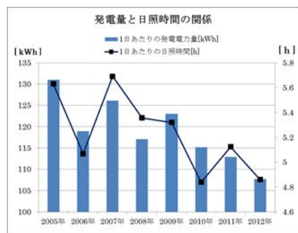
図1 都城高専の1日あたりの発電電力量(棒グラフ)と日照時間(折れ線グラフ)の関係
