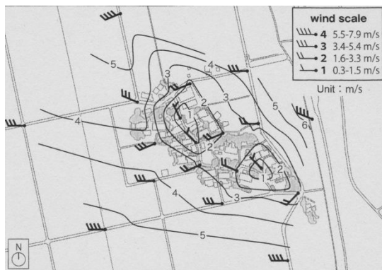
図2 二日町集落における風向風速の観測結果 (2013年12月8日10時)
