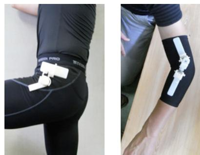
図4 股関節(左)と肘(右)の関節計測モジュールの設計とプロトタイプング
