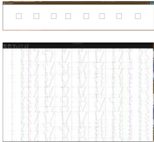
図9. バネブロックモデルの数値シミュレーション（上：実行画面，下：ブロックの変位や力などの時系列図示）
