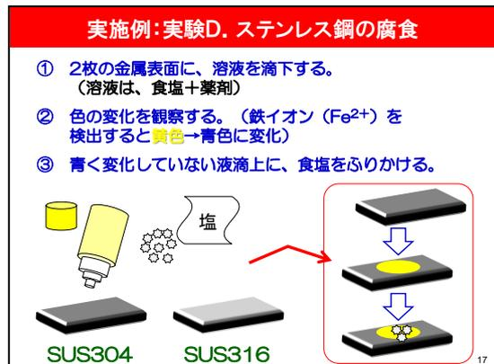
図4. 小中学生向けマイクロスケール腐食実験テキスト例
