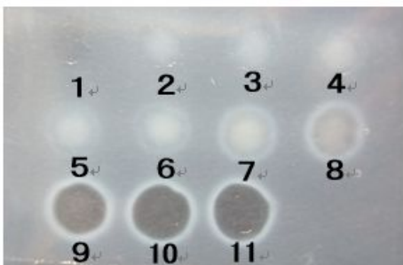
図3 カゼインを含む寒天プレートでのプ ロテアーゼの半定量的活性測定。 使用酵素： Aspergillus mellens 由来の 170 U/mL proteinase (Type XXIII). 酵素反応 温度：A~C, 30。酵素反応時間：60 分間； 希釈倍率：1， 蒸留水； 2， x 1500 ( 2.3 \times 10^{-3} U)； 3， x 1000 ( 3.4 \times 10^{-3} U)； 4， x 750
