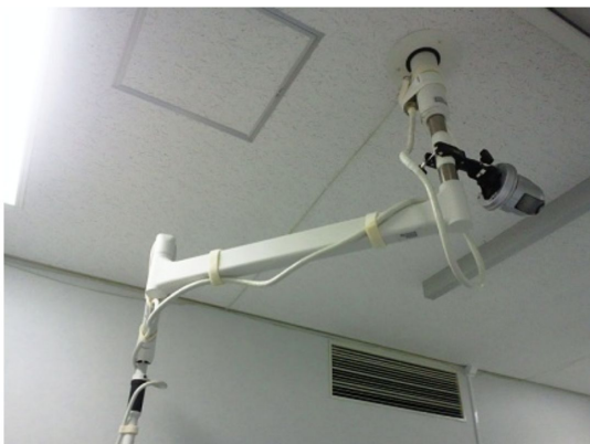
図 2 手技室に設置したカメラ（手技を上方 から撮影する）
