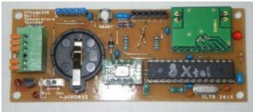
図 15 記録計部 (AT mega328P 使用) 基板
