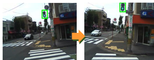
図 3 歩行者横断用信号機検出と信号認識結果の一部 (晴天, カメラが傾いた場合). 青信号を緑色の枠で表示。
