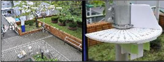
図7 ミラー実験 (左: 実験用ミラー, 右: 角度測定部)
