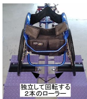
図6 計測で用いた2本ローラー台
