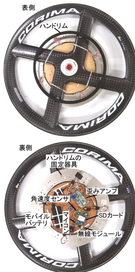
図 2 開発した計測用ホイール
