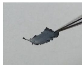
図5 基板から自立した Fe@CNT シート。
