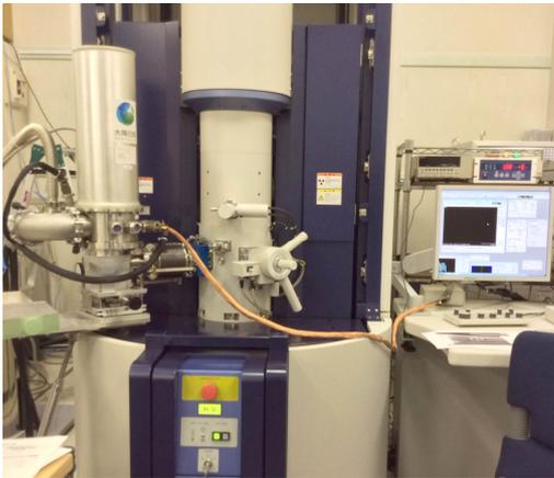
図 4. JST 先端計測(要素技術)で開発した TES 型 X 線検出器を搭載した、新たに導入した走査透過型電子顕微鏡。
