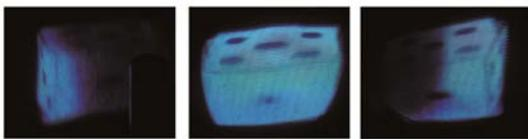
図6 ミラー停止状態での空中像
