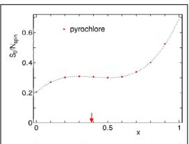
図3:パイロクロア格子上の希釈反強磁性イジングモデルの残留エントロピーの希釈度依存性。破線は一般化された Pauling 近似
