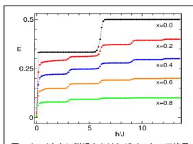
図 2:[111]方向に磁場をかけたパイロクロア格子 上の希釈反強磁性イジングモデルの磁化曲線
