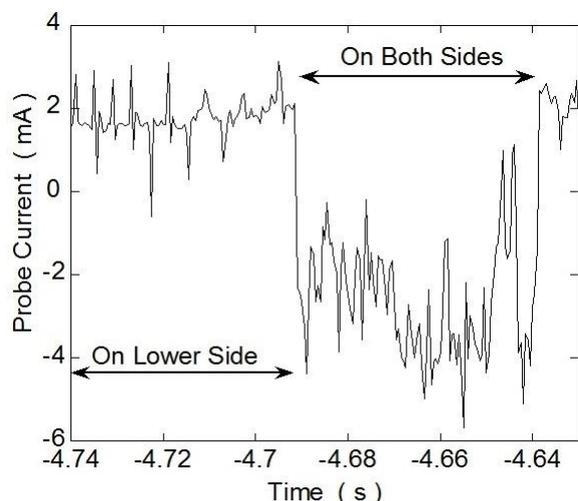
図 10 陰極点が試験片裏側にある状態から両面にある状態へ変化するときのプローブ電流の時間変化
