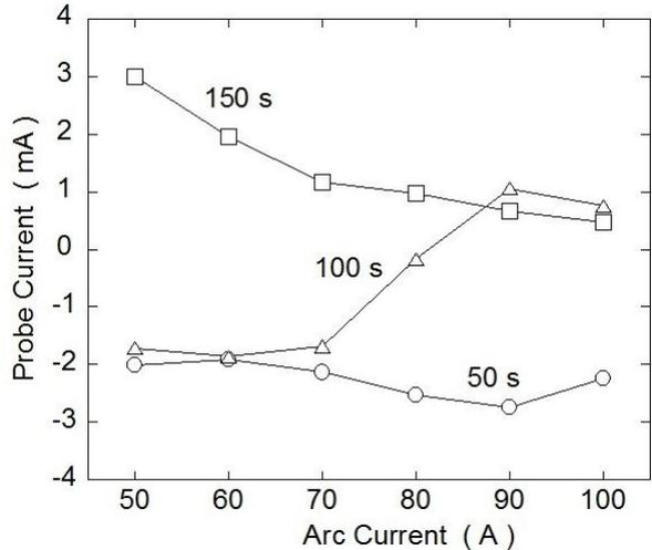
図7 プローブ電流のアーク電流に対する変化
