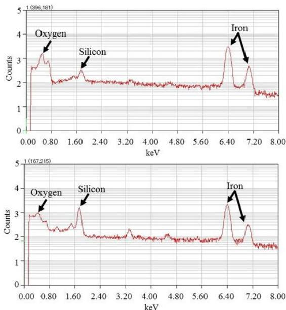
図 11 陰極点が試験片表側にある場合（上）と裏側にある場合（下）の電極間プラズマ中浮遊物質の元素分析結果
