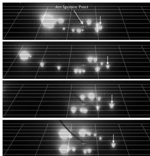
図3 酸化膜上での陰極点移動の高速度撮影写真
