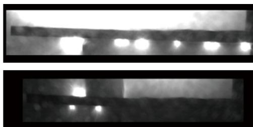
図 9 陰極点が試験片裏側にある状態（上）から両面にある状態(下)に変化したときの様子
