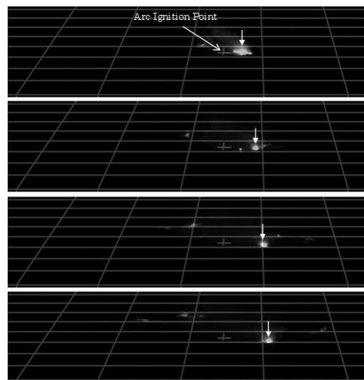
図4 酸化膜除去後の試験片表面上での微小高速輝点移動の高速度撮影写真
