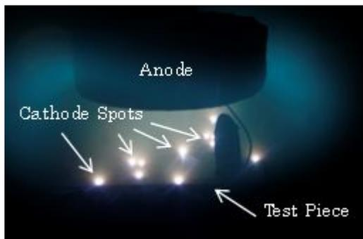
図1 酸化膜を除去中の陰極点
