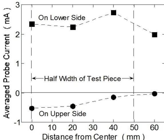
図8 試験片に平行方向のプローブ電流の分布
