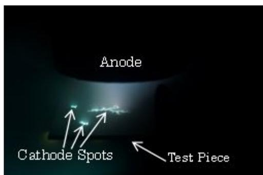
図2 酸化膜除去後の陰極点
