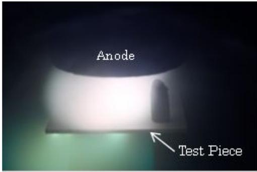
図5 陰極点がすべて試験片裏側にある時の電極間の様子
