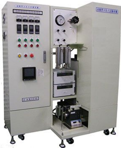
図7．株式会社 AKICO と共同開発したナノエマルジョン製造装置「SFW-E40S」。
