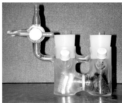
Figure 4. H字型充放電セル
