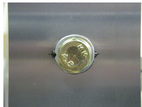
図5 ボルト穴からのき裂進展に伴う黒発色
