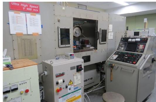
**図 1** 実験に用いた超高速研削盤
