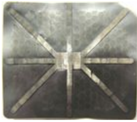
(b) 両者を超音波接合したサンプル 図 1.3 チタン箔と薄板の超音波接合例
