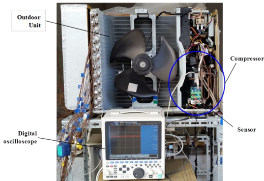
図 9 3 軸加速度センサーを用いたロータリー圧縮機回転数の測定システム概略
