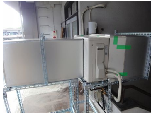
図 1 性能測定に用いたルームエアコンの室外機空気エンタルピー測定用ダクト
