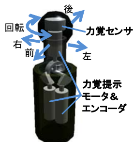
図5 3自由度力覚提示ジョイスティック
