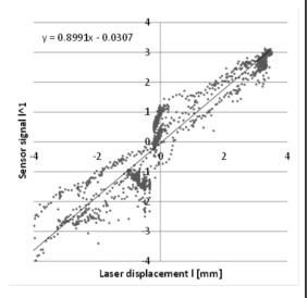
(ウ)一定の変位 ( -2mm ~ 2mm, 0.5mm 刻み )を与えて固定した状態で正弦波交流電圧( sin(2 t) [V] )を加えた. 入力電圧のみが変動する場合のセンシング性能を調べた.このグラフから,出力電圧に位相差が生じていることが確認できるが,これは, IPMC が有するコンデンサ成分が影響していると考えられる.
