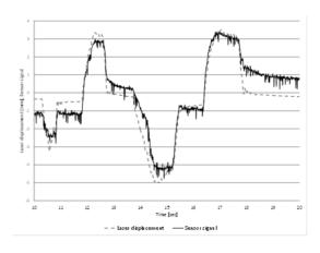
以上のことからセルフセンシングするため に必要な相関がるあることを認めることが できた.しかしながら,センサとして使用す る際には,さらなる精度,並びに,アクチュ エータ電圧が小さい時の零割の対策が必要 である.
