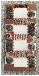
図9 2直列型ヒューズの遮断試験後の様子
