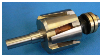
図10 2次試作回転子写真
