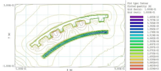
図2. 超電導風力発電機の磁束分布の例
