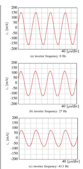
図 5 従来法における漏えい電流の拡大波 形
