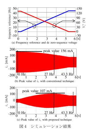
156mAとなり、インバータの出力周波数の増加に伴って減少する。これは周波数が増加するにつれてインバータ各出力相の同時スイッチングが発生しなくなり、インバータの出力する零相電圧の変化率が小さくなるためである。図5に、図4(b)の結果において代表的な出力周波数(0Hz, 27Hz, 43.3Hz)での拡大波形を示す。図5より、漏えい電流波形の振動周波数はいずれも10kHzであり、出力周波数の増加に伴って振幅は減少していることが確認できる。さらに、いずれの周波数においても波形形状はほぼ正弦波であることが確認できる。
