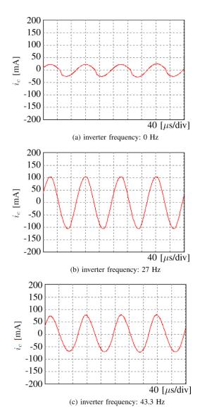
図6 提案法における漏洩電流の拡大波形
