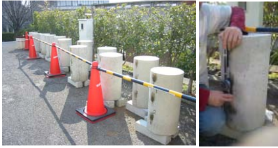
写真1 屋外暴露の大型コンクリート供試体（左）と膨張率測定状況（右）
