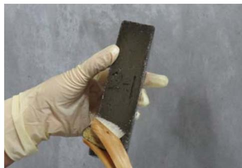
写真-1 供試体への被膜剤の塗布
