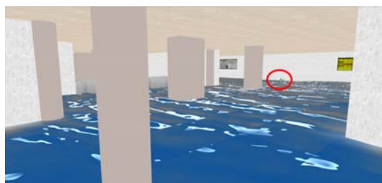
図2 駅構内浸水過程の立体的可視化
