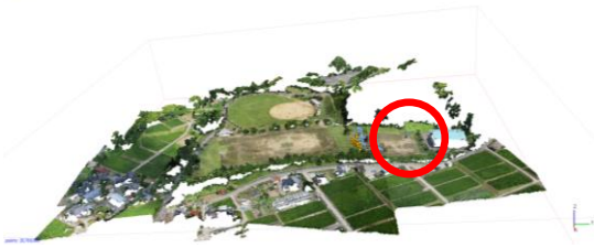
図8 GCPの追加(高密度点群モデル)
