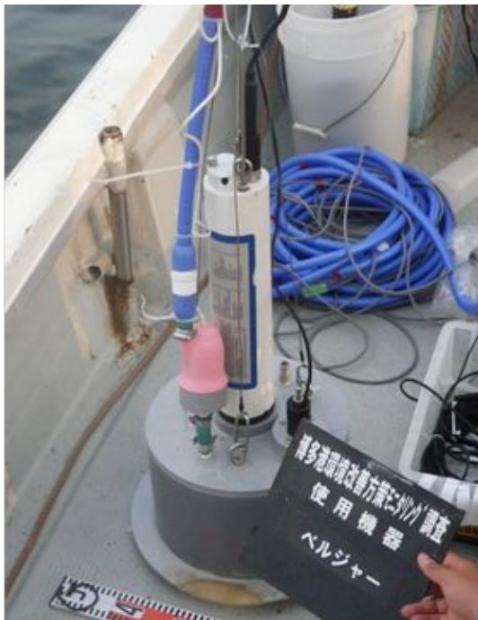
写真-1 酸素消費速度測定装置ベルジャー
