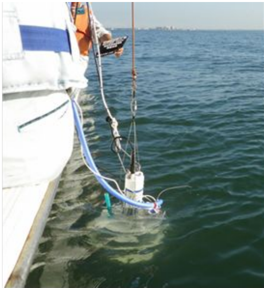
写真-2 ベルジャーを海中に設置する様子
