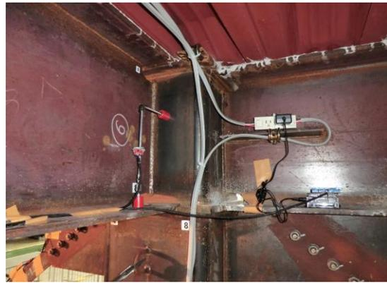
図 1.3 角速度センサ設置状況
