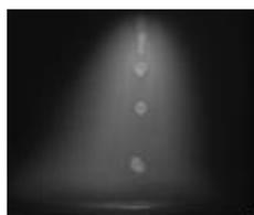
図3 電流パルス化の溶滴移行への効果
