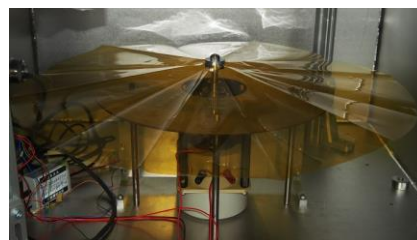
図7. ジグザグ折り回転円形膜面加振実験
