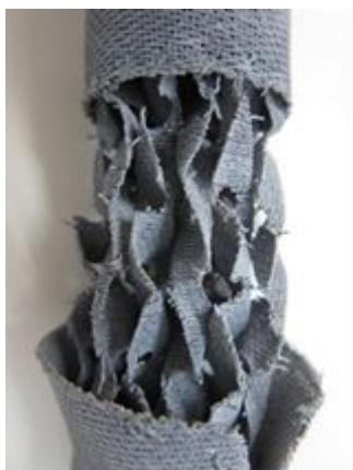
図6 規則成形型疎水性白金触媒（試作品）
