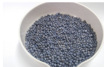
図5 粒状疎水性白金触媒 (粒径 3mm) TKK-JADE (市販開始品)
