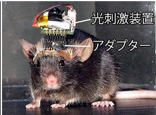
(図. 2) 新規無線光刺激装置(赤外線通信を使用)
