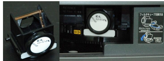
図 1 . 発光専用ダイクロックミラーと装着状態
