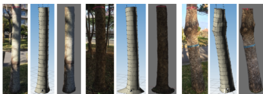
図6. 写真測量と3次元位置測定装置による3Dモデルの比較
