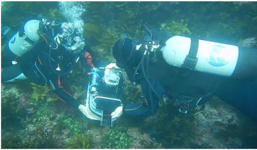
図 9 ハンディマルチ蛍光撮影装置を用いた実海域における蛍光撮影調査
