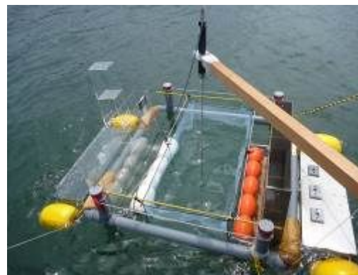
図-12 実海域における波浪エネルギー吸収効率測定実験
