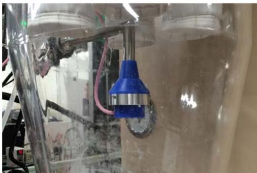
図4. 造粒容器内に設置されたノズル電極
