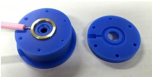
図2. ノズル電極の主要部品
