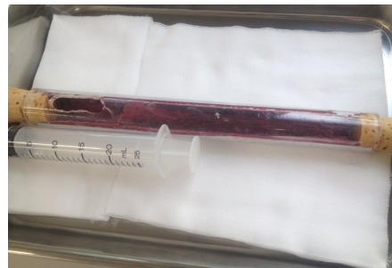
Fig.8 擬似血栓生成技術を応用した気道粘膜モデル
