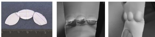
扇形の弁尖 弁尖を人工血管内に縫着 バルサルバ洞様の膨らみ
