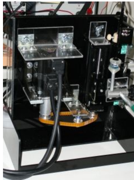
【荷重装置動作制御部】 (左;サーボモーター,右;リニアアクチュエーター,これらの回転軸はタイミングベルトを介して連動している)
