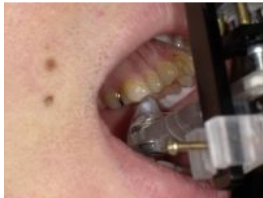
【荷重装置荷重部の初期位置】 （荷重部先端はシリコンゴムでコーティングし、口腔内挿入部分は感染防護用のディスプレイブルカバーで被覆されている）
