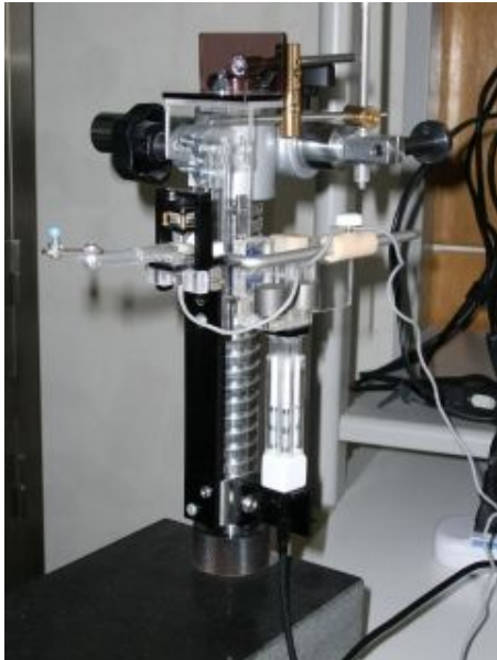
【荷重装置（校正用スタンドに設置） （中央下のシリンダーをその直下のケーブルリリース金属芯が押し上げることによって荷重部が上方に移動する）
