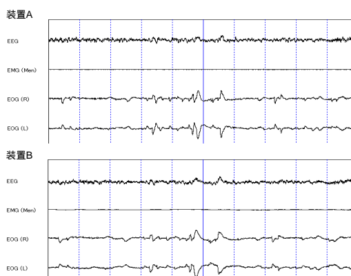
図 9 レム睡眠時の生体現象の比較の例 (装置 A:無線テレメータシステム,装置 B:ポータブル記録装置を用いた生体現象記録システム)
